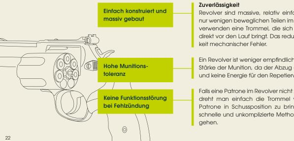
Revolver sind massive, relativ einfache Konstruktionen mit nur wenigen beweglichen Teilen im Vergleich zu Pistolen. Sie verwenden eine Trommel, die sich dreht und die Patronen direkt vor den Lauf bringt. Das reduziert die Wahrscheinlich-
